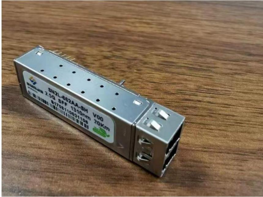
性能可靠的SFF光模块与其他光模块有什么区别呢？与SFP的区别：SFP光模块被称为小封装可插拔产品，它被形象的比喻为是SFF光模块的可插拔版本。SFP光模块的数据信号接口与SFF光模块接口具有趋同性，它还提供其他的控制接口，而且兼容其它系列标准的光接口。SFP光模块与SFF光模块的相同点是都不包含Serdes部分，但是SFP光模块的功耗小且尺寸也要更小。与GBIC的区别：GBIC是指千兆接口转换器，据专业提供光模块厂家介绍，它即是将千兆位电信号与光信号进行转换的一种接口器件，从体积上来说它要比SFF光模块更大，从工艺上来说它是使用pcb板焊接，但目前基本已被SFP和SFF光模块作取代，它的功能性上基本与SFF光模块相一致，尤其一些交换机厂家所使用的SFF光模块的耐用性很高。光模块协议sff8636供货价格
