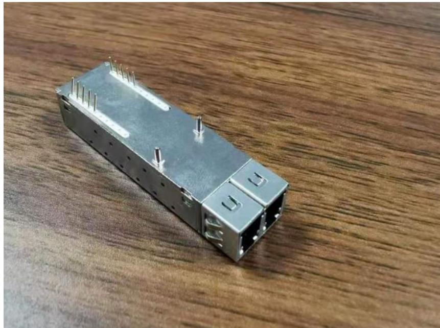
SFF光模块色散的产生主要是因为不同波长的电磁波在同一介质中传播时速度不等, 从而造成光信号的不同波长成分由于传输距离的累积而在不同的时间到达接收端, 导致脉冲展宽, 进而无法分辨信号值。因此, 用户需要根据自己的实际组网情况选择合适的光模块, 以满足不同的传输距离要求。中心波长: 中心波长指光信号传输所使用的光波段。目前常用的光模块的中心波长主要有三种: 850nm波段、1310nm波段以及1550nm波段。850nm波段: 多用于≤2km短距离传输。1310nm和1550nm波段: 多用于中长距离传输(2km以上的传输)。光模块协议sff8636供货价格。SFF光模块工作温度范围宽实用性强。
